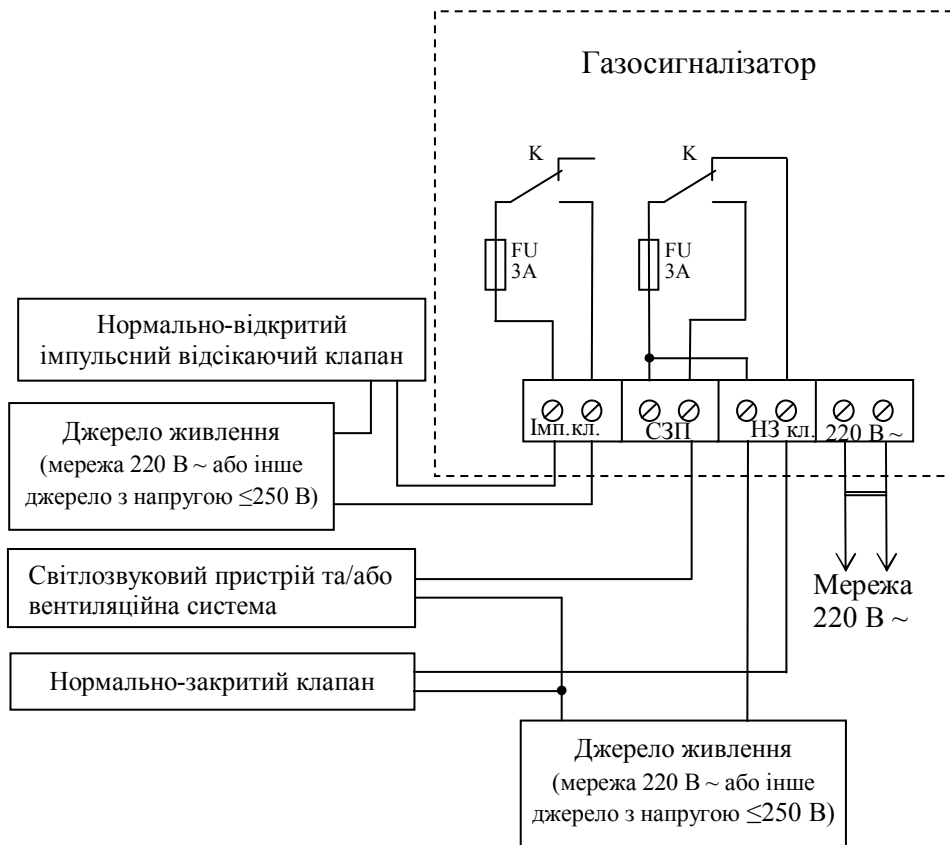
Рисунок 2. Схема підключення газосигналізатора «Страж 2SxxA2х» (з типом управляючих виходів № 2) до нормально-відкритого відсікаючого електромагнітного клапану (типу EVG/NA, EVRM-NA, M16/RM-NA та ін.), світлозвукового пристрою, нормально-закритого електромагнітного клапану з потенціальним або імпульсним керуванням.
